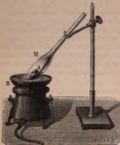
Fig. 155. — Préparation du sulfure d'arsenic.
